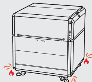
La découpe d'un matériau près des bords de la zone de travail peut provoquer des étincelles jaillissant du bas de l'appareil. Éloignez de l'appareil les matériaux inflammables, les explosifs et les solvants volatils. Les opérateurs doivent se tenir à au moins 50 cm de la zone d'éclaboussure d'étincelles.
