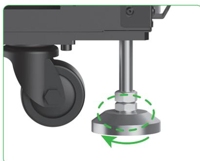
Utilisez une clé pour serrer les écrous inférieurs dans le sens des aiguilles d'une montre.
