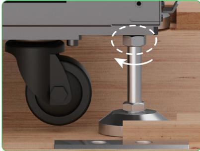
Utilisez la clé pour tourner les écrous supérieurs dans le sens des aiguilles d'une montre jusqu'à ce qu'ils touchent les écrous inférieurs.
